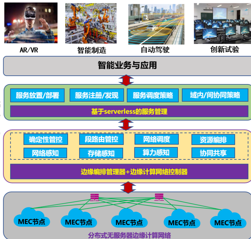
图 2-1 无服务器边缘计算网络的参考架构
