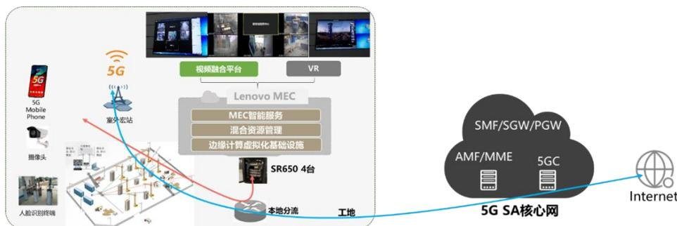
图 10: 基于 5G+边缘计算的智慧工地方案
