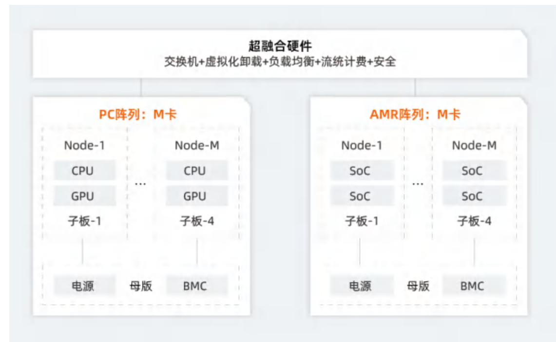
图3 超融合硬件架构图
